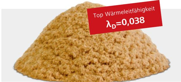
Für STEICOzell wird ausschließlich frisches Nadelholz verwendet, das nach den strengen Regeln des PEFC zertifiziert ist. Ein geringer Anteil an Ammoniumsalzen (<5 %) garantiert die dauerhafte Materialbeständigkeit sowie den sicheren Brandschutz.
