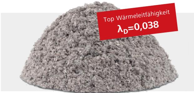
Für STEICOfloc wird ausschließlich sortiertes Tageszeitungspapier verwendet. Dies wird in einer modernen Wirbelstrommühle zerfasert. Die dauerhafte Materialbeständigkeit sowie der Brandschutz werden hier durch einen geringen Anteil an anorganischen Mineralsalzen gewährleistet.
